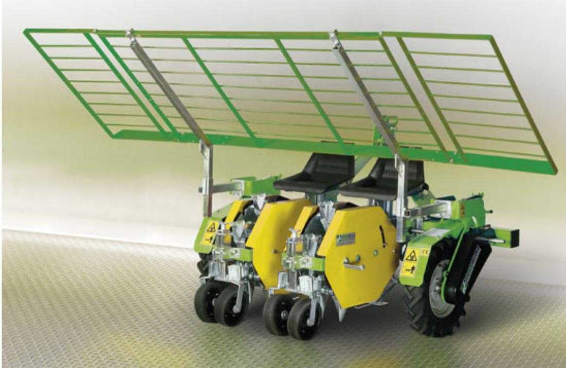
Die Pflanzmaschine OVER + OVER PLUS kann auf Böden, auf die man die Folie schon gelegen hat, oder auf nacktem Böden pflanzen. Diese Maschine ist mit keiner Pflanzschar ausgerüstet: die Pflanzen werden direkt auf dem Boden durch Becher gepflanzt. Für das OVER Modell ist die min. Reihenabstand 40 cm. Dagegen ist die min. Reihenabstand mit dem Modell OVER PLUS 32 cm.
