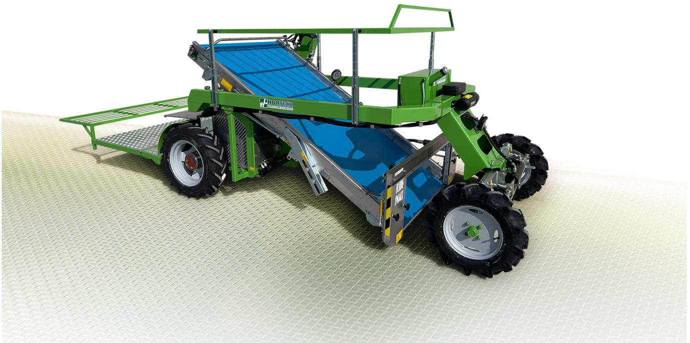
SLIDE SMALL ist für alle Bauern geplant worden, die in kleinen Gewächshäusern arbeiten, aus diesem Grund ist das Schnittaggregat in dem Rahmen montiert. Die Schnitthöhe wird von einer mechanischen Walze oder von einem proportionalen elektro-hydraulischen Sensor kontrolliert, um eine vollkommene Höekontrolle zu garantieren. SLIDE SMALL ist mit 2 Treibräder auf ihrer Vorderseite ausgerüstet.
