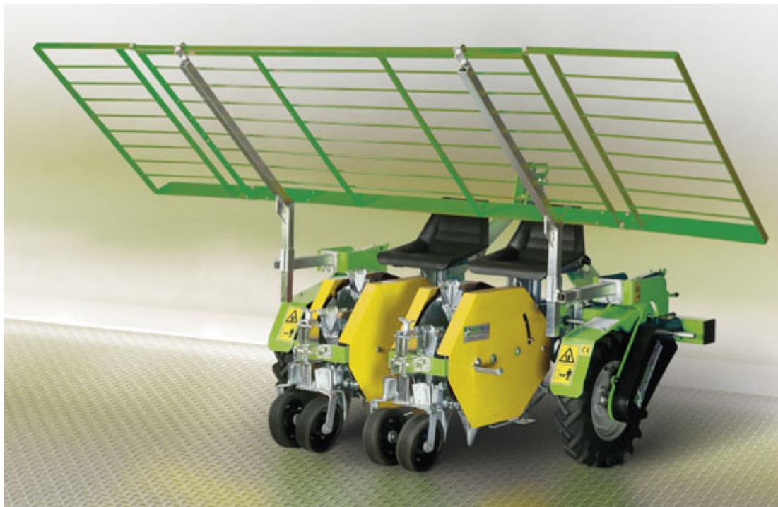
Les repiqueuses OVER et OVER PLUS peuvent repiquer soit sur des terrains nus ou déjà paillagées. Ce système de repiquage ne nécessite pas de socs car le godet distributeur pénètre dans le sol et positionne la plante. OVER peut être acheté avec la poseuse de paillage modèle P. La distance entre les rangs avec le modèle OVER est minimum de 40 cm, tandis avec le modèle OVER PLUS est minimum de 30 cm et maximum 50 cm.
