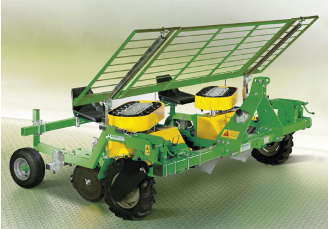
Practica Duo repique tous les légumes sur tous les types de sol. Le système de chargement elliptique, à double rang avec 12 godets, permet d'avoir une plus grande capacité de chargement des plantes, car c'est possible pour l'opérateur de charger 2 éléments simultanément. Elle est équipée avec une single porte plante à lutrin et avec des roues de compactage.
