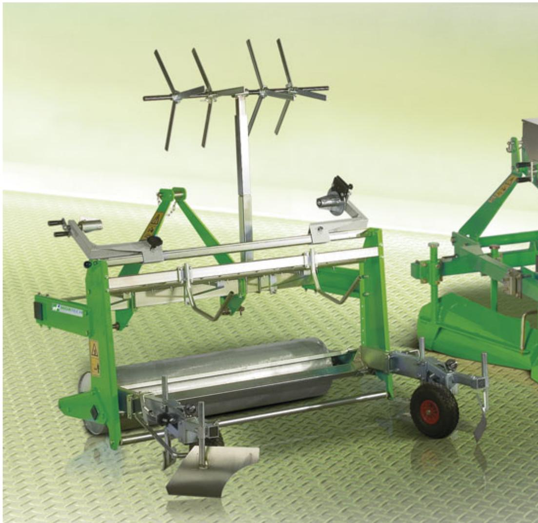
Регулируемое устройство, подходит для укладки полиэтиленовой, бумажной пленки, а также биоразлагаемого укрывного материала. Выпускается в двух версиях: модель Р140 для пленки шириной до 140 см, модель Р190 для пленки шириной до 190 см. Обе модели могут оснащаться резиновыми колесами и/или передним валиком.
